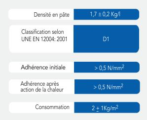
Données obtenues dans des conditions normales de laboratoire  $23 \pm 2^{\circ}$ C et  $50 \pm 5^{\circ}$ HR < 0,2 m/s
